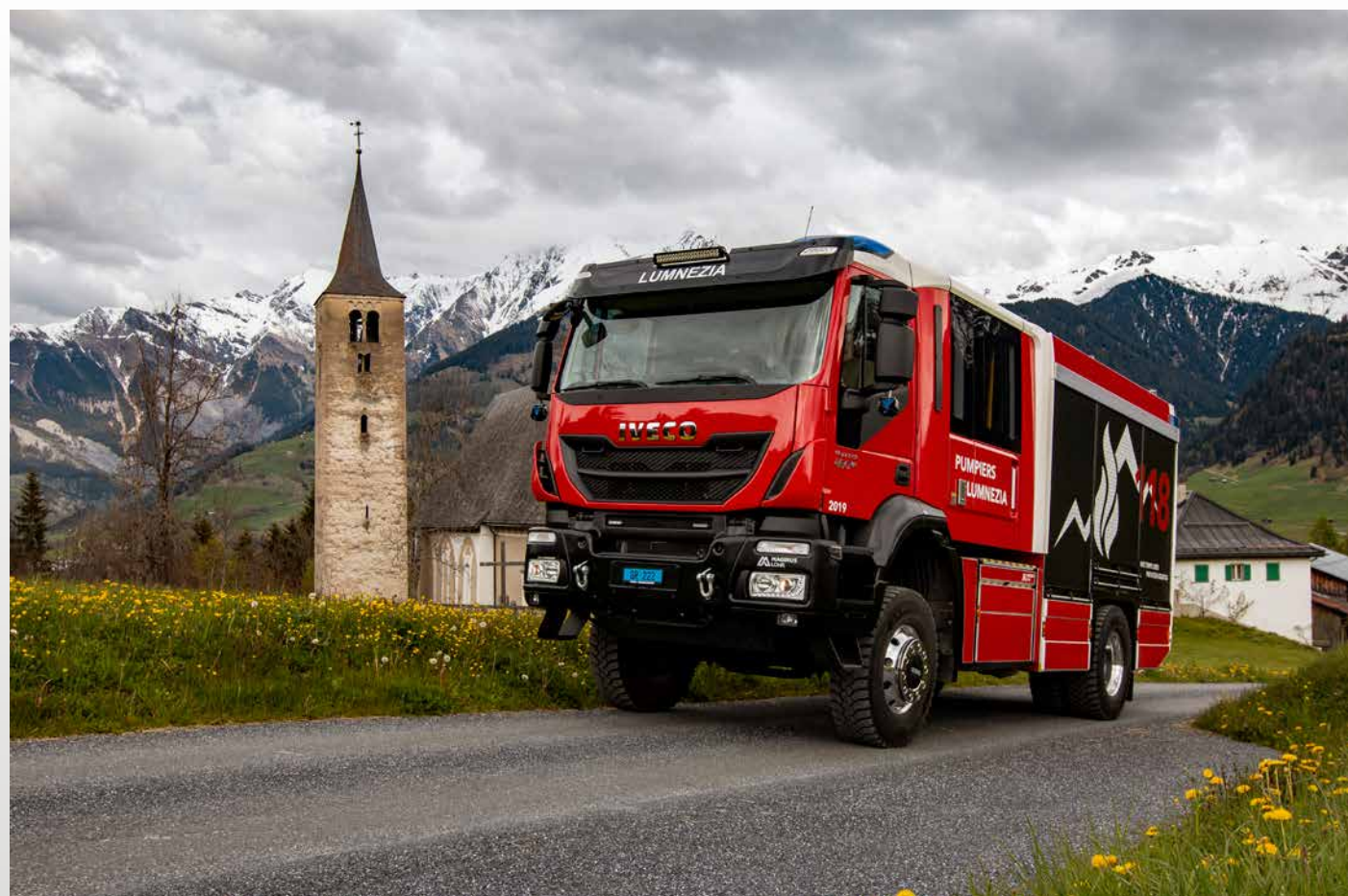
Igl auto cistiarna ei in camiun dalla marca Iveco cun 450ps. El sa transportar otg persunas (incl. il manischnunz), 3000 liters aua e massa material. Sis persunas san sesemtgar durant il viadi cun apparats da schurmetg da flad.
