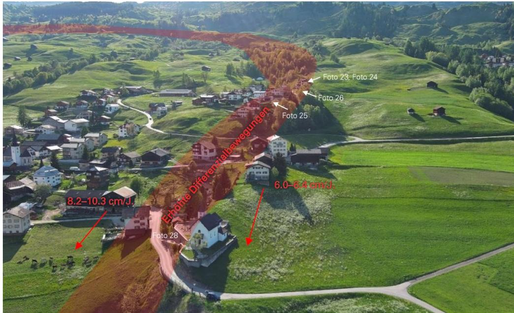
Foto 22: Vignogn (2°731'725 / 1°173'532, Drohnenaufnahme, Blickrichtung WNW). Rot eingefärbt ist die Zone mit erhöhten Differentialbewegungen von 3–4 cm/Jahr aufgrund von unterschiedlichen Bewegungsraten benachbarter Rutschungsschollen (rote Pfeile).
